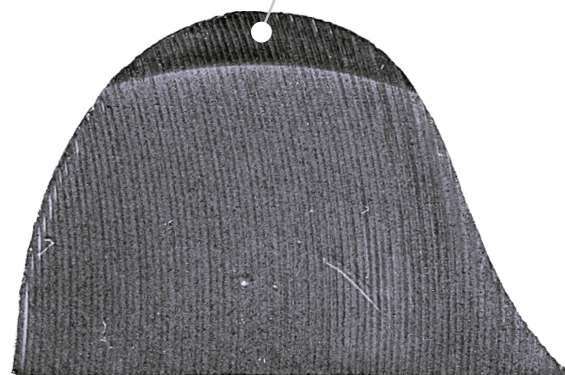
МАКРОШЛИФЫ ГРЕБНЯ КОЛЁСНОЙ ПАРЫ ПОСЛЕ УПРОЧНЕНИЯ
