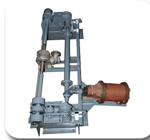
Механизм вращения колёсной пары (при обработке выкаченных колёсных пар или под локомотивом)
